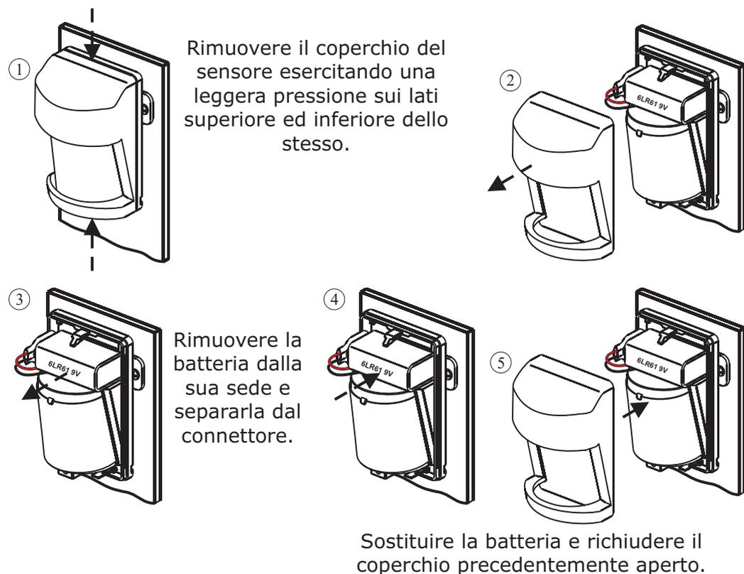
Rimuovere il coperchio del sensore esercitando una leggera pressione sui lati superiore ed inferiore dello stesso.
