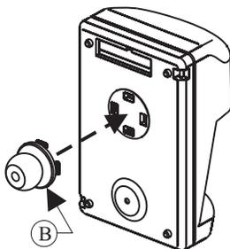
Inserire la parte sferica del particolare (B) nell'apposita sede sferica della staffa "A".
