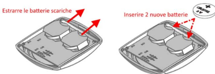
**ATTENZIONE:** Utilizzare solo batterie di tipo CR2032. L'utilizzo di batterie differenti da quelle consigliate potrebbe danneggiare irrimediabilmente il sensore. Le batterie esauste devono essere smaltite negli appositi contenitori.
