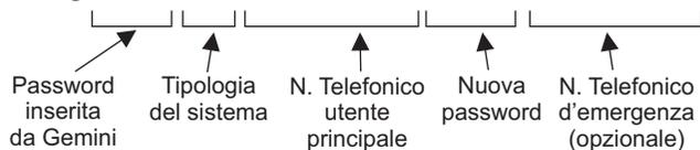
A seguito dell'invio della stringa di configurazione, il sistema invierà al mittente un SMS indicante: **configurazione ok con password=AA1234**
