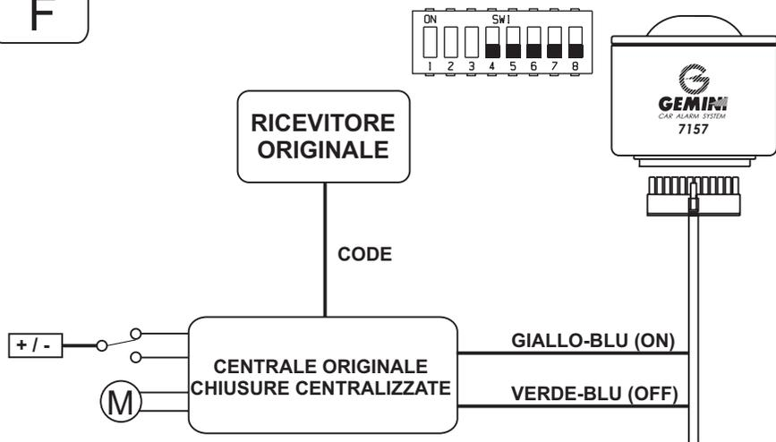
Schema per ricevitore codificato e centrale di comando chiusure con predisposizione per il collegamento ad un sistema di allarme
