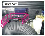
**Versioni 1.6, 1.9JTD, 2.4 Abarth:** praticare 2 fori da 6 mm. sul contenitore plastico del vano batteria e fissare la staffa con gli appositi bulloni inserendo, all'interno del contenitore, le ranelle di sostegno prima di avvitare i dadi. (Figura "C").
