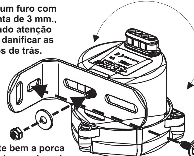
Aperte bem o parafuso de fixação.
