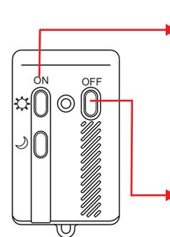
Per **ABILITARE** la funzione premere una sola volta il **TASTO "ON"**.
