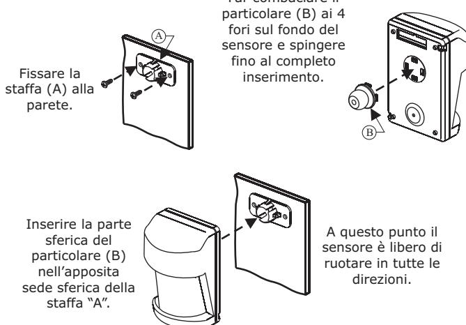
Regolare il sensore a seconda dell'area da proteggere ed effettuare delle prove di funzionamento.
