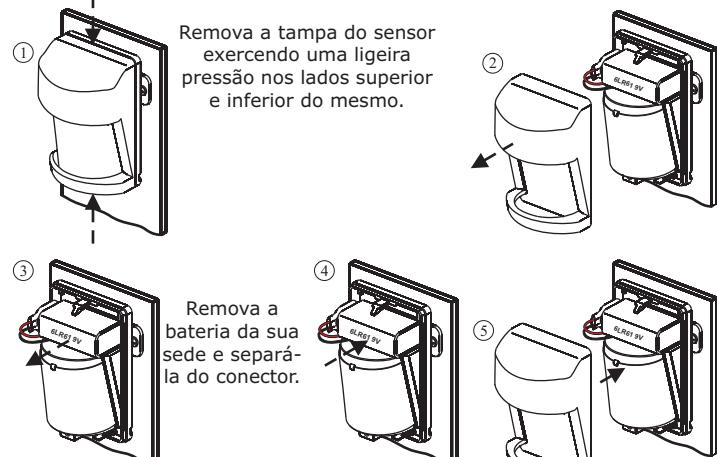
Substitua a bateria e feche novamente a tampa removida anteriormente.
