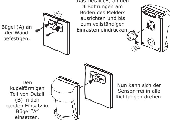
Den Sensor je nach dem Schutzbereich ausrichten und Funktionstests durchführen.
